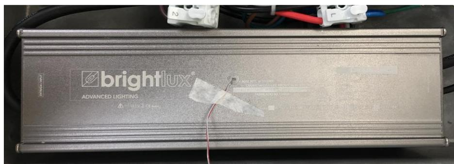
**II.B.6.3 - Posicionamento do termopar no ponto tc do dispositivo de controle**
